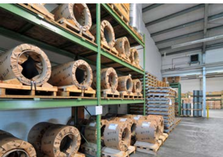
Stockage des bobines avec traverses en bois
