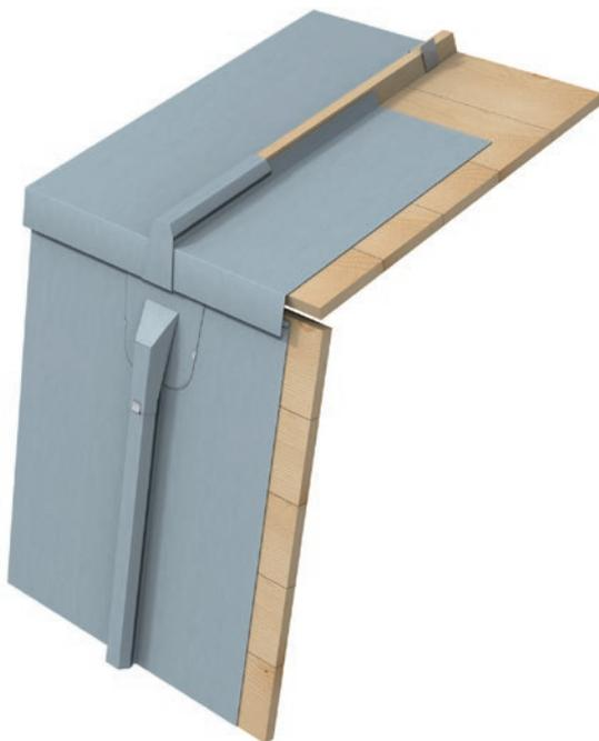
En raccord avec le larmier, on peut interposer une bande de battellement ou un membron.
