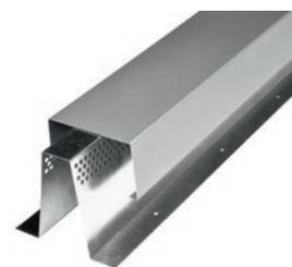
Faîtage ventilé (double pente section 224 cm<sup>2</sup>/m, monopente et monopente contre mur section 112 cm<sup>2</sup>/m)
