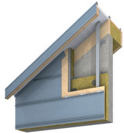
Haut de bardage sous rampant
