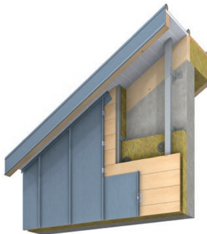
Haut de bardage sous rampant
