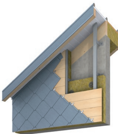
Haut de bardage sous rampant
