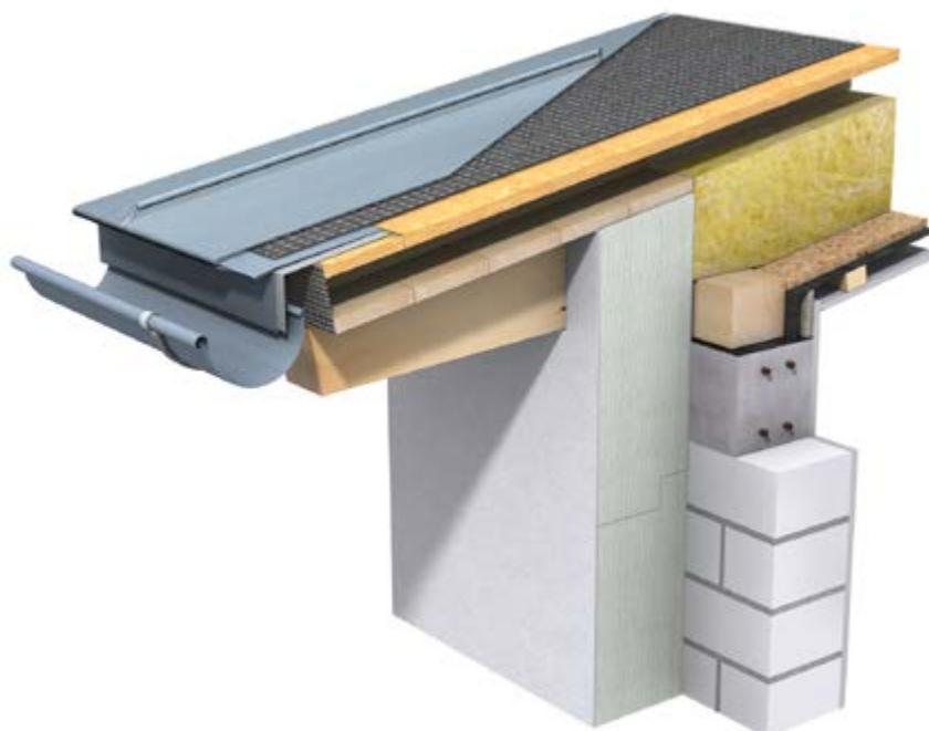
Construction de toiture ventilée avec support en panneaux de particules et isolation thermique entre les chevrons.
