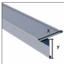
Bandes d'égout, 2 pattes de fixation par pièce
