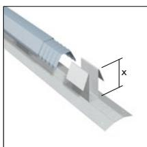
**Faîtage ventilé double pente, 5 pattes de fixation par pièce, 1 profilage d'agrafage UDS par pièce**
