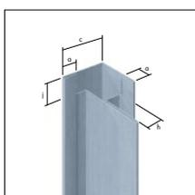
**Profils d'angle extérieur avec pièce de jonction**
