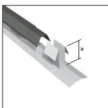
**Faîtage ventilé double pente, 5 pattes de fixation par pièce, 1 profilé d'agrafage UDS par pièce**
